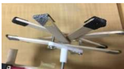
圖 1:冰棒棍寬度及厚度示意圖。冰棒棍長為 11.4cm、寬為 1 cm。
